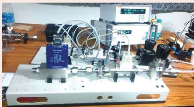
चित्र 1 : मास फ्लो कंट्रोलर के लेमिनर मोलब्लॉक द्वारा अंशांकन का फोटोग्राफ
